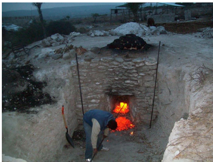
Fotografía 2.5 Cocimiento de la piedra en la manzana Baxcajay
